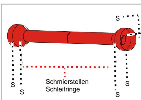
Bei starker Auslastung oder bei extremen Arbeitsbedingungen, wie starker Staumentwicklung, ist häufigeres Schmieren notwendig.
