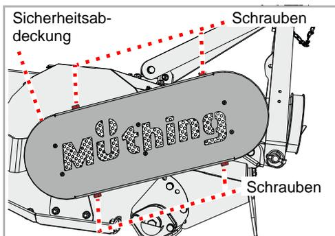
Der Antriebsriemen wird über einen Schlitten gespannt. Wenn der Antriebsriemen nicht ausreichend gespannt ist, muss er nachgespannt werden. Zeigen sich Risse oder ist der Antriebsriemen beschädigt, muss er ausgetauscht werden.
