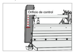
La correa se tensa mediante un carro. Es necesario volver a tensar la correa cuando esté floja. Sustituya la correa si presenta grietas o daños.
