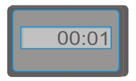
Un contador electrónico de horas de servicio muestra el tiempo real de funcionamiento. Esto permite registrar datos exactos y utilizarlos para hacer cuentas, por ejemplo.
