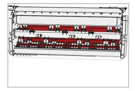
Una pieza metálica insertada protege la carcasa frente al desgaste.
