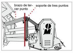
▶ Ajustar el brazo de tercer punto de manera que el soporte de tres puntos quede vertical
