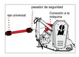
El concesionario ha adaptado el eje universal a su tractor. Normalmente el eje universal ya está conectado a la máquina. Si se sustituye el eje universal o este se somete a trabajos de mantenimiento, deberá volver a conectarlo a la máquina.
