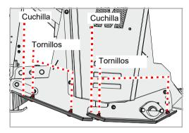
Hay dos cuchillas colocadas en el lado derecho y en el lado izquierdo.
