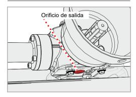
▶ Coloque un depósito de recogida para el aceite usado debajo del orificio de salida
