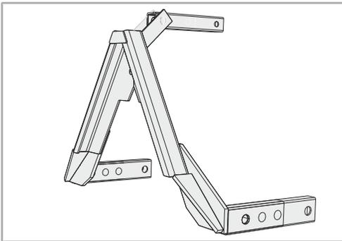
Acoplamiento triangular estándar para el montaje en tractores con triángulo del tractor en montaje frontal con la categoría:
