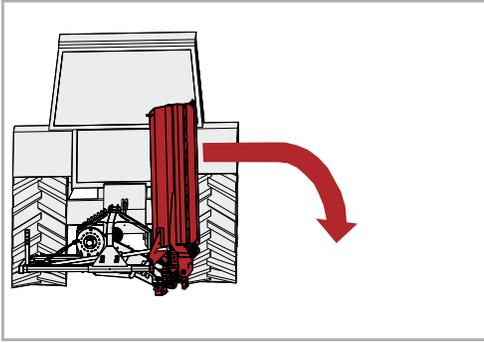
Die Position der Maschine hinter dem Traktor können Sie einstellen. Dabei kann die Maschine stufenlos nach rechts verschoben werden.
