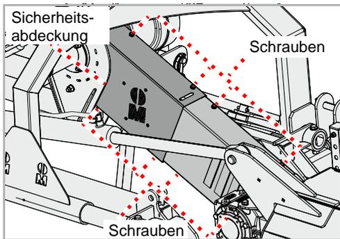
Der Antriebsriemen wird über eine Feder gespannt. Wenn der Antriebsriemen nicht ausreichend gespannt ist, muss er nachgespannt werden. Zeigen sich Risse oder ist der Antriebsriemen beschädigt, muss er ausgetauscht werden.
