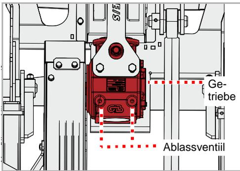
Das Ablassventil befindet sich unter dem Getriebe.
