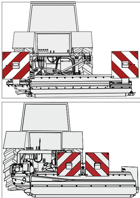
Pour le transport de la machine sur route, des panneaux de signalisation avec dispositifs d'éclairage intégrés sont disponibles.
