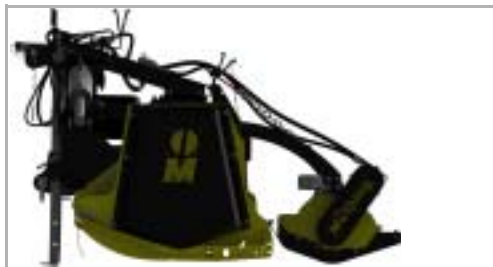
Anbau direkt hinter dem Mulcher, ohne Stützwalze
